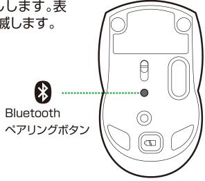
5 ペアリング候補が表示されるので選択します。数秒後、ペアリングが完了します。
